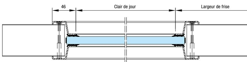
**Vitrage avec profilé en acier en applique** sans raccord visible côté paumelles pour vitrage rectangulaire et hublot (standard)
