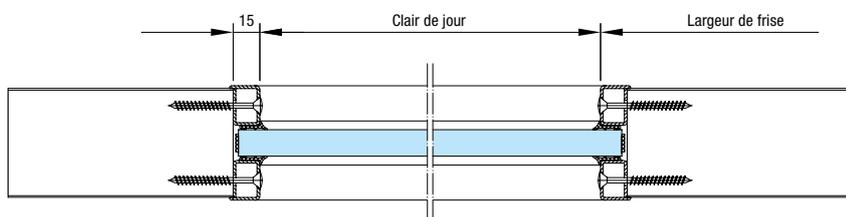
**Vitrage avec profilé en acier affleurant** pour vitrage rectangulaire (uniquement possible pour portes MZ et El<sub>2</sub>30)
