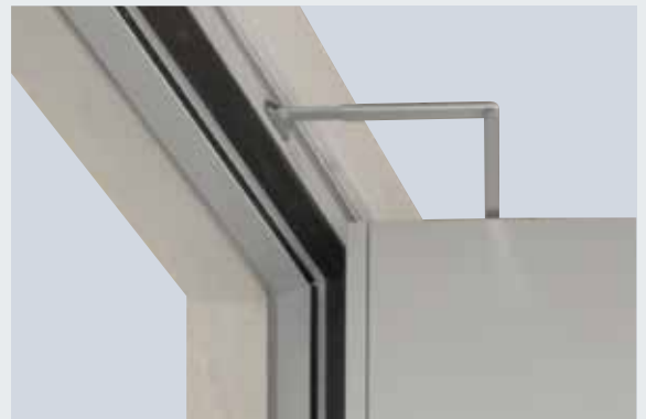
Huisserie tubulaire 140 / 75 mm, en 3 éléments, avec rainure d'étanchéité continue sur 3 côtés
