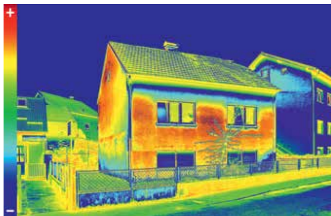
Relevé thermographique d'une maison
