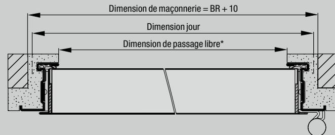
\* Sans prise en compte de poignées ni de béquilles, la largeur de passage libre pour un angle d'ouverture de 90° diminue de 25 mm.
