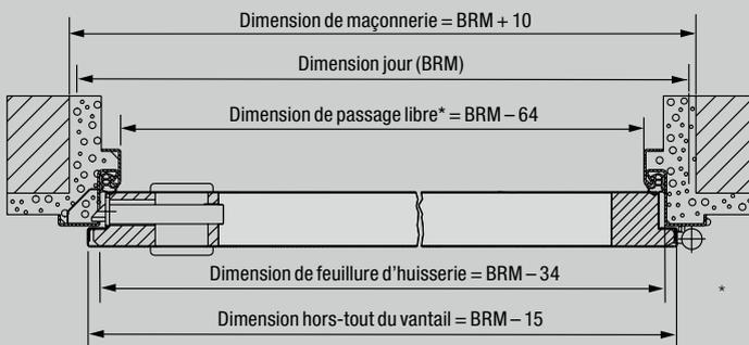
\* Sans prise en compte de poignées ni de béquilles, la largeur de passage libre pour un angle d'ouverture de 90° diminue de 2 mm.
