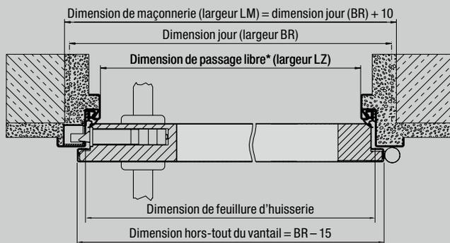
\* Dimension de passage libre = largeur BR - 64 mm, hauteur BR - 32 mm. Sans prise en compte de poignées ni de béquilles, la largeur de passage libre pour un angle d'ouverture de 90° diminue de 2 mm.
