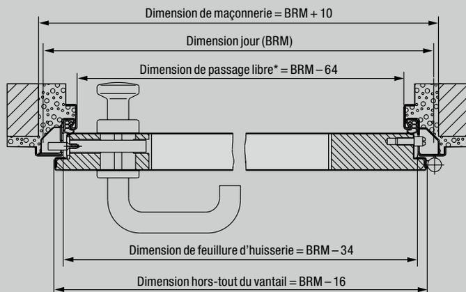
\* Sans prise en compte de poignées ni de béquilles, la largeur de passage libre pour un angle d'ouverture de 90° diminue de 2 mm.
