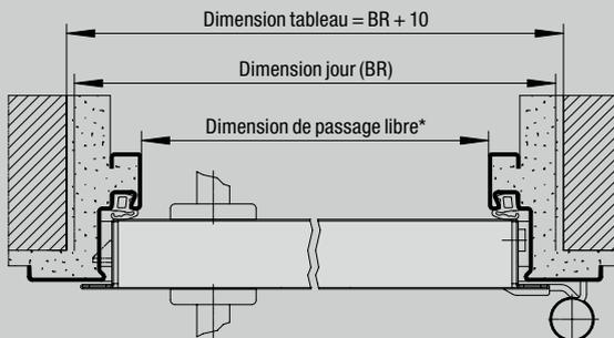
\* Sans prise en compte de poignées ni de béquilles, la largeur de passage libre pour un angle d'ouverture de 90° diminue de 113 mm (feuillure mince) et de 103 mm (feuillure épaisse).
