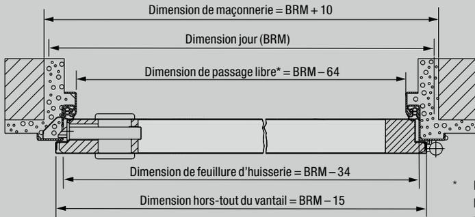
\* Dimension de passage libre = largeur BR - 64 mm, hauteur BR - 32 mm. Sans prise en compte de poignées ni de béquilles, la largeur de passage libre pour un angle d'ouverture de 90° diminue de 2 mm.
