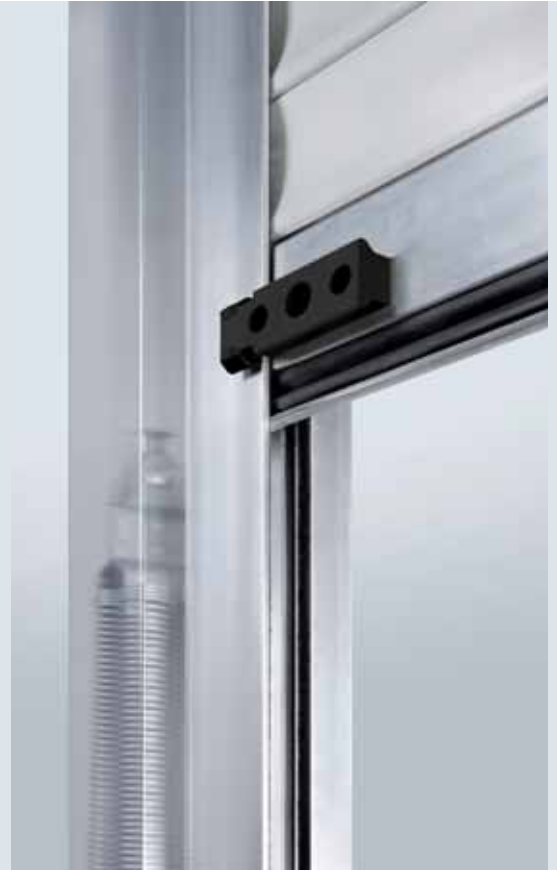
Technique à ressorts de traction et rail de guidage en aluminium avec profils synthétiques à glissière intérieurs et joints à brosses
